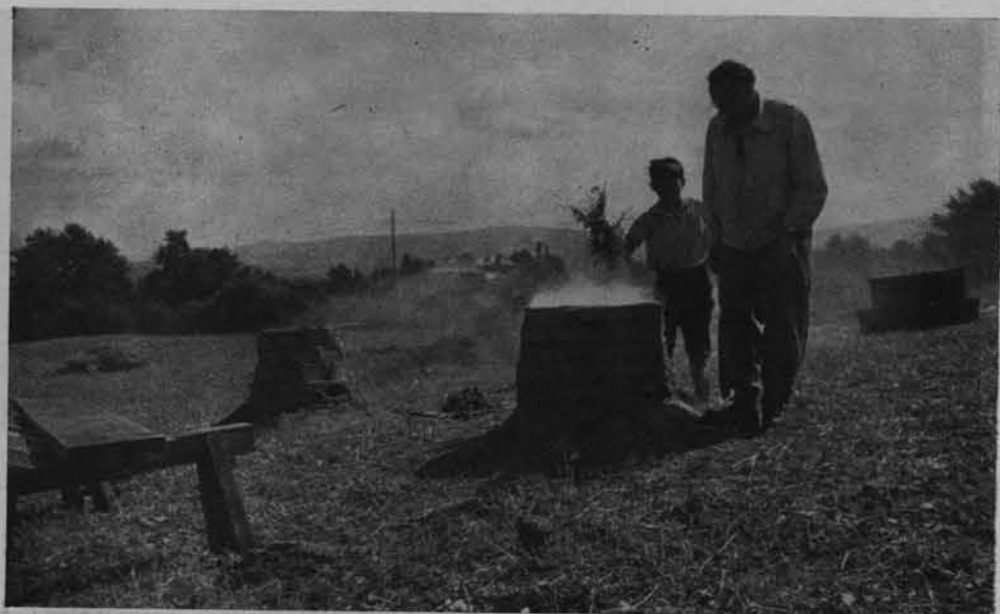
Stupia Nowa. Badania doświadczalne nad wytopem żelaza w zrekonstruowanym piecu typu kotlinka świętokrzyska. Faza przygotowawcza — suszenie pieców
